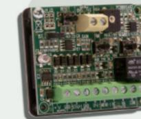
**DIANATOP** in versione sensore converte il segnale generato dai sensori di tipo impulsivo (come i cordini per tapparelle) in un segnale aperto/chiuso di un relè.
